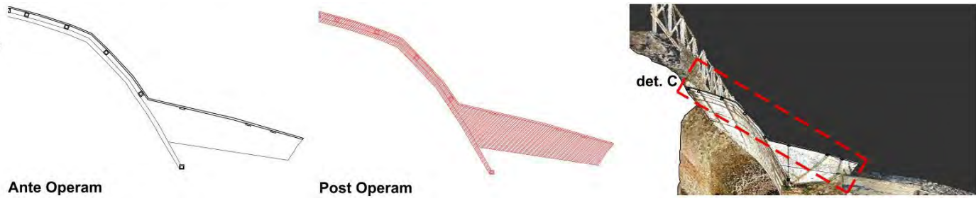
Figure 51 - Detaj dhe pamje e strehës që aktualisht mbulon pjesën e parë të galerisë horizontale pranë hyrjes
